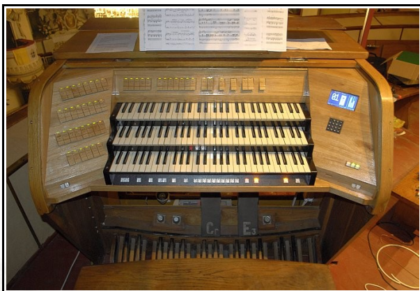
Kontuar po modernizacji i zainstalowaniu OrgNG1.0
