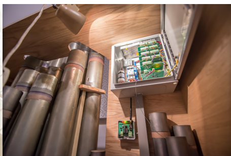
Fragment mobilnego instrumentu bezprzewodowego pracującego w systemie OrgNG3.0 - sterownik oraz moduł komunikacji radiowej
